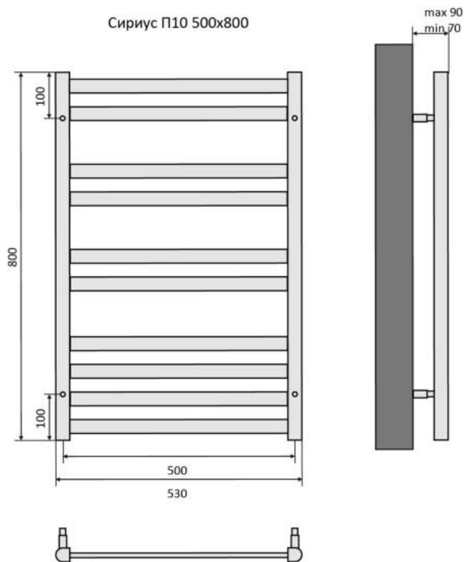
Схема подключения полотенцесушителя к системе ГВС
